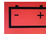
Ladekontrollleuchte: Strom kommt aus der Batterie
