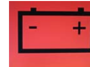
Ladepolekontrollleuchte: Strom kommt aus der Batterie
